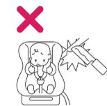
차내의 날카로운 부분에 의해 카시트의 모든 벨트류에 흠집이 발생하지 않도록 주의하시고, 차내에 가급적 위험한 물건은 보관하지 마세요. It shall be recommended that any luggage or other objects liable to cause injuries in the event of a collision shall be properly secured.
