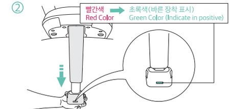
서포트 레그 조절 버튼을 눌러 차량 바닥 면에 닿게 고정시킨 후 서포트 레그 앞쪽 인디케이터 색상이 빨간색에서 초록색으로 변경되었는지 확인한다.
